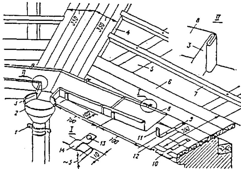
**Рис. 29. Устройство настенного желоба**
