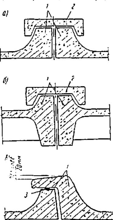
**Рис. 36. Конструкции стыков кровельных панелей**
