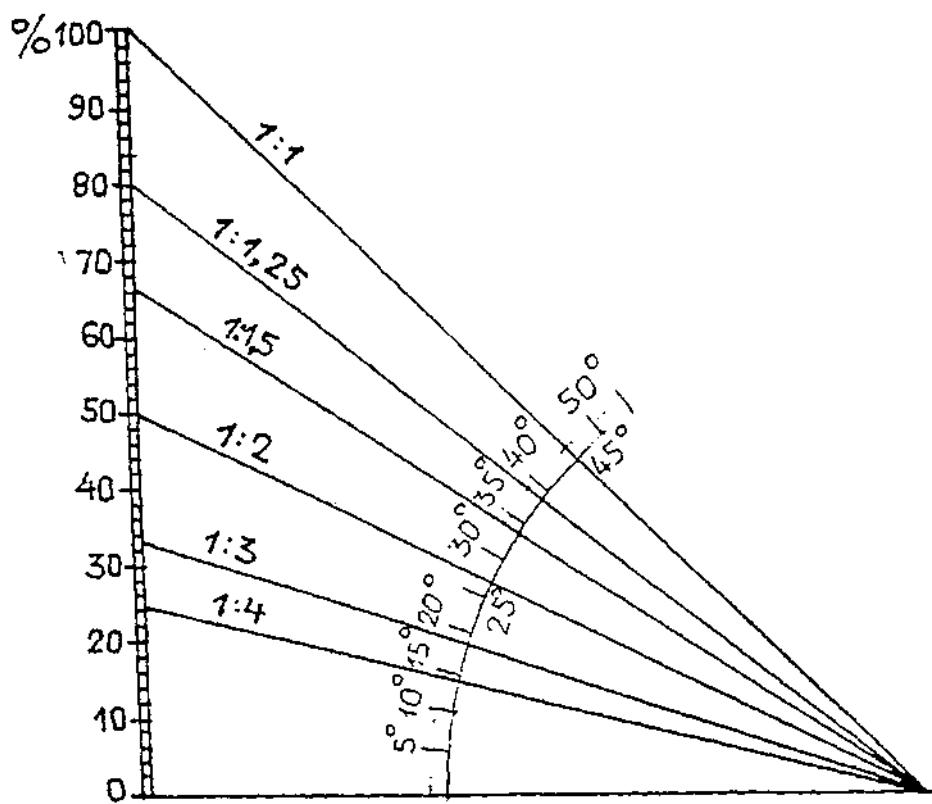
Рис. 3. График для определения величины уклона в %.
