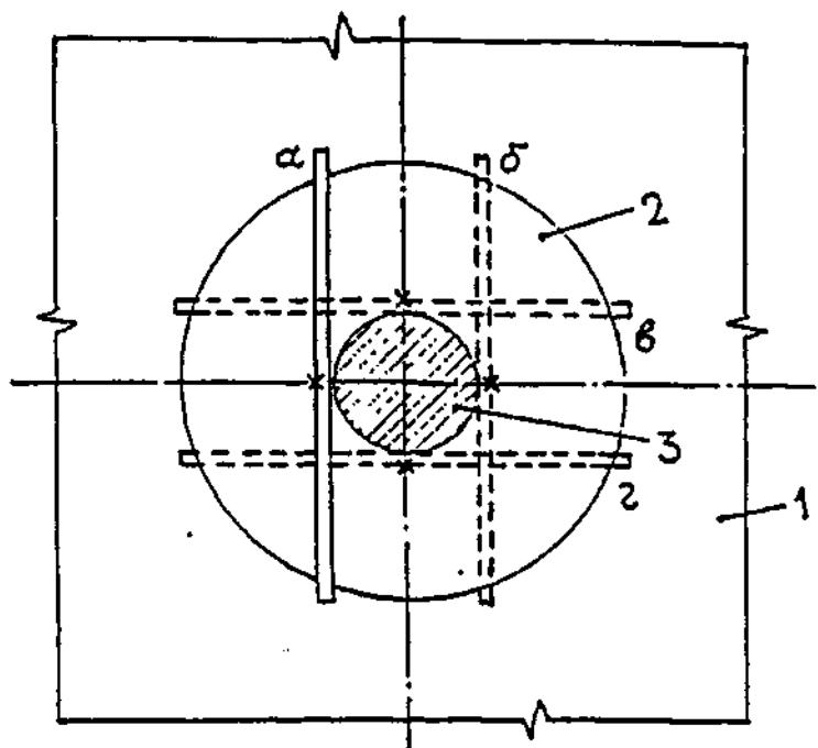
Рис. 4. 1 - поверхность кровельного ковра; 2 – зона понижения уровня кровли; 3 – водоприемный колпак воронки; а, б, в, г – расположение рейки; х – места замеров.
