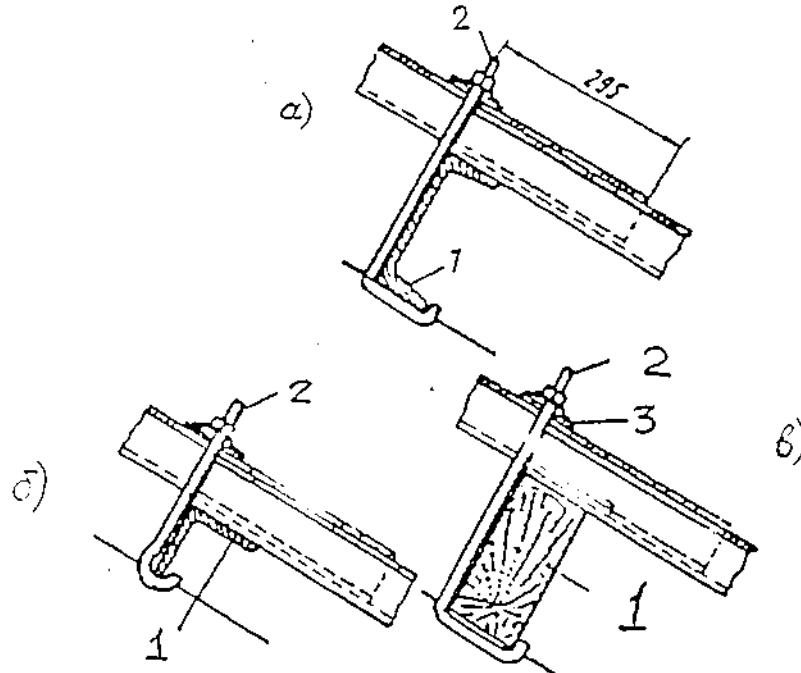
**Рис 19.1 Способы крепления асбестоцементных волнистых листов к прогонам**
