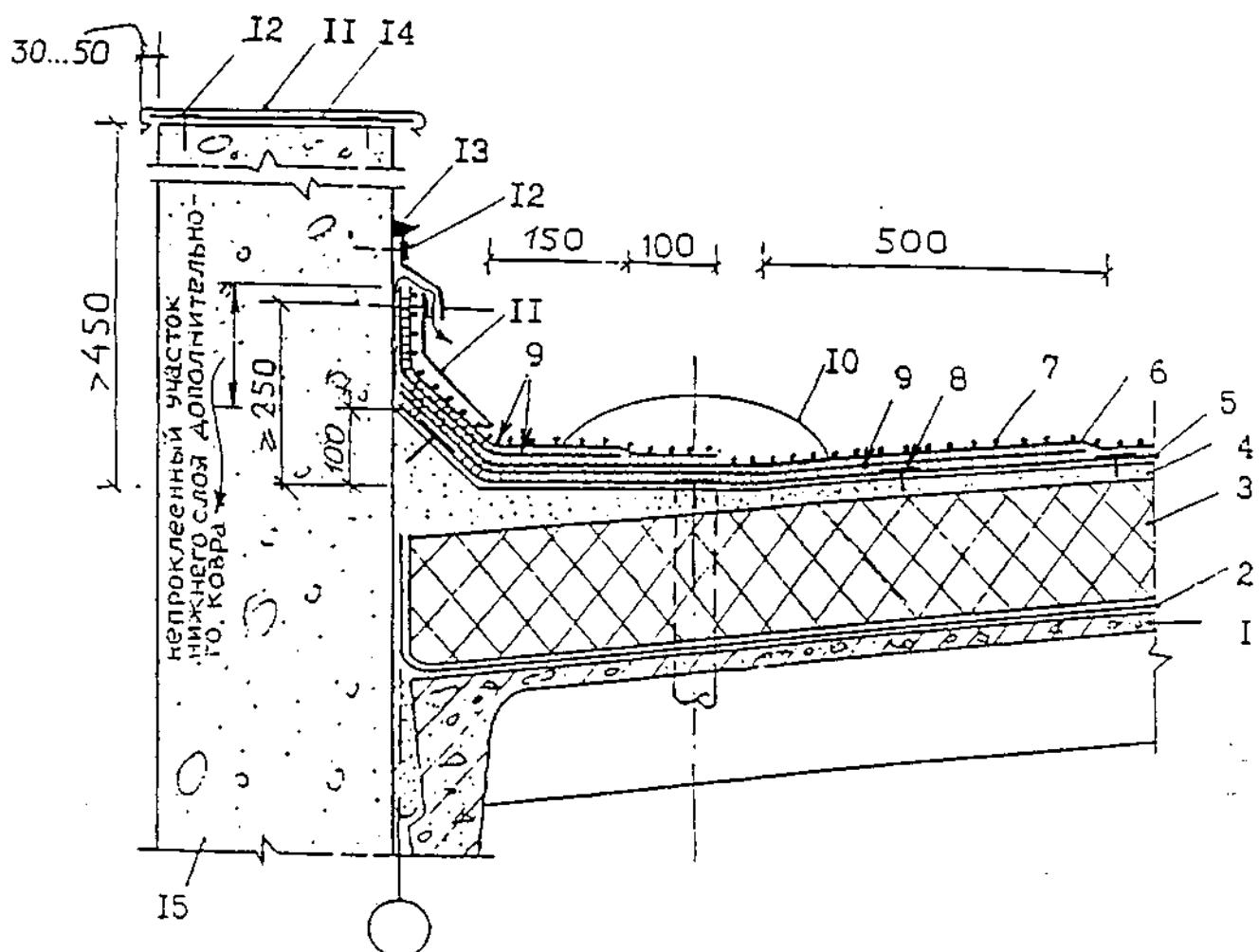
**Рис. 15. Примыкание кровли к парапету высотой более 450 мм при механическом закреплении нижнего слоя водоизоляционного ковра**
