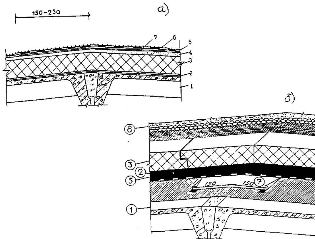
**Рис. 9. Конек кровли**
