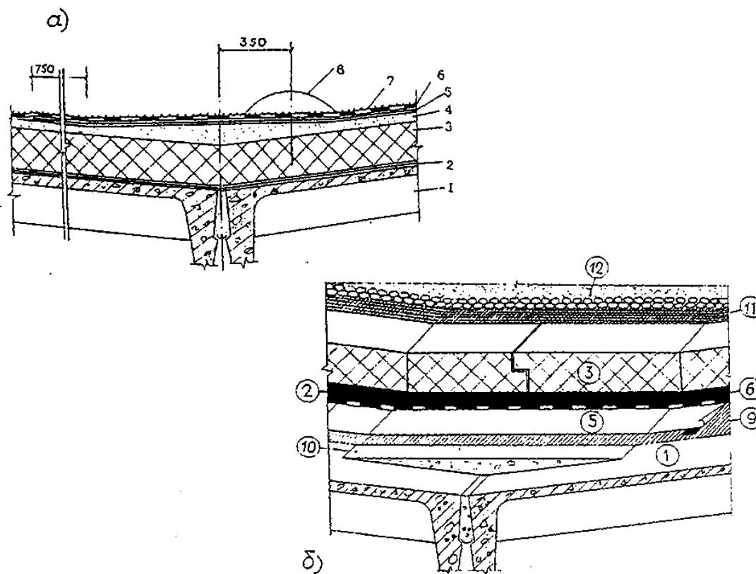
**Рис. 10. Ендова кровли**
