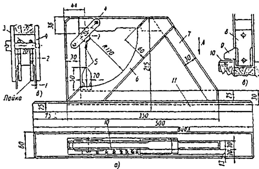
**Рис. 2.** а) боковой вид. б) – разрез шарнира, в) нижняя часть маятника. 1 – стальная пластина; 2 – проволочное кольцо; 3 – латунная ось; 4 – планка; 5 – маятник; 6 – направляющая; 7 – рамка; 8 – груз; 9 – указатель; 10 – шкала; 11 - опорная рейка.
