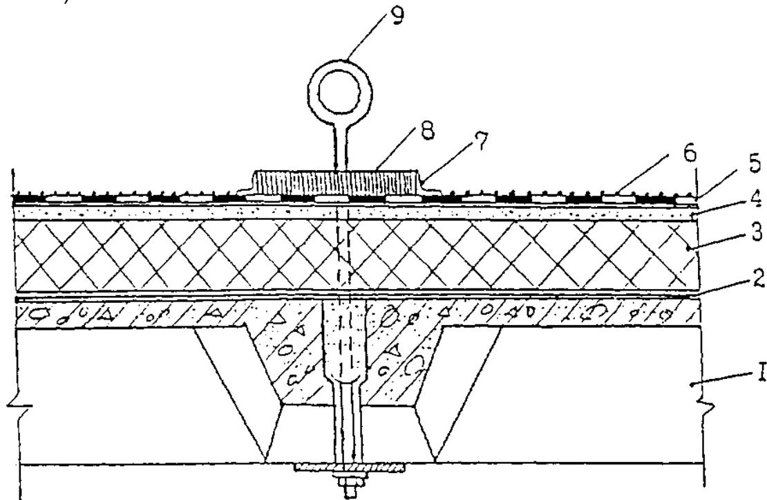
**Рис. 3. Пропуск анкера через водоизоляционный ковёр**
