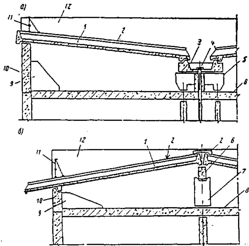
**Рис. 35. Конструктивные схемы сборных железобетонных безрулонных крыш**
