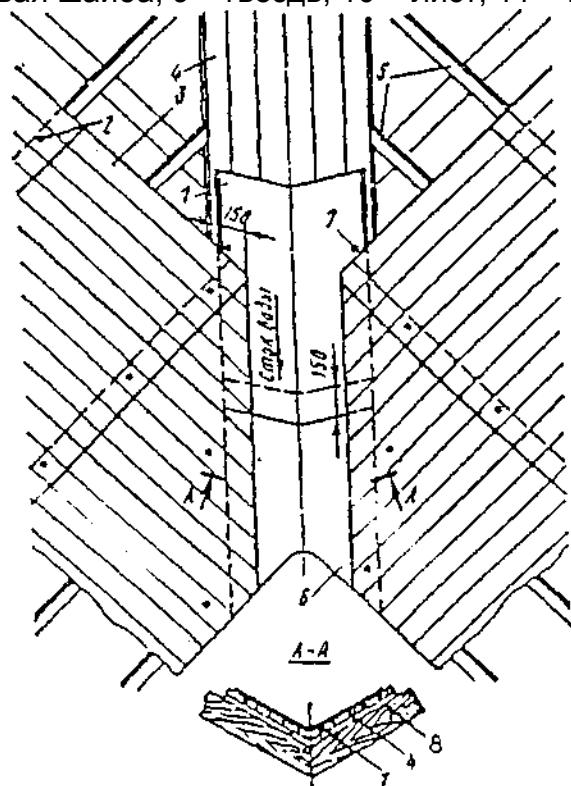
**Рис.20. Устройство ендовой (разжелобка)**
