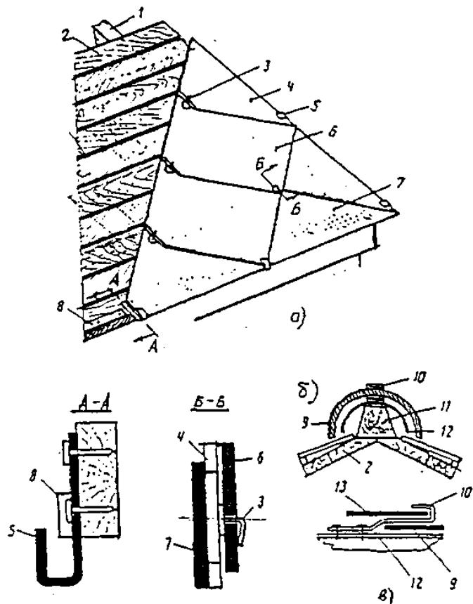
**Рис. 24. Конструкция кровли из асбестоцементных плоских плиток**
