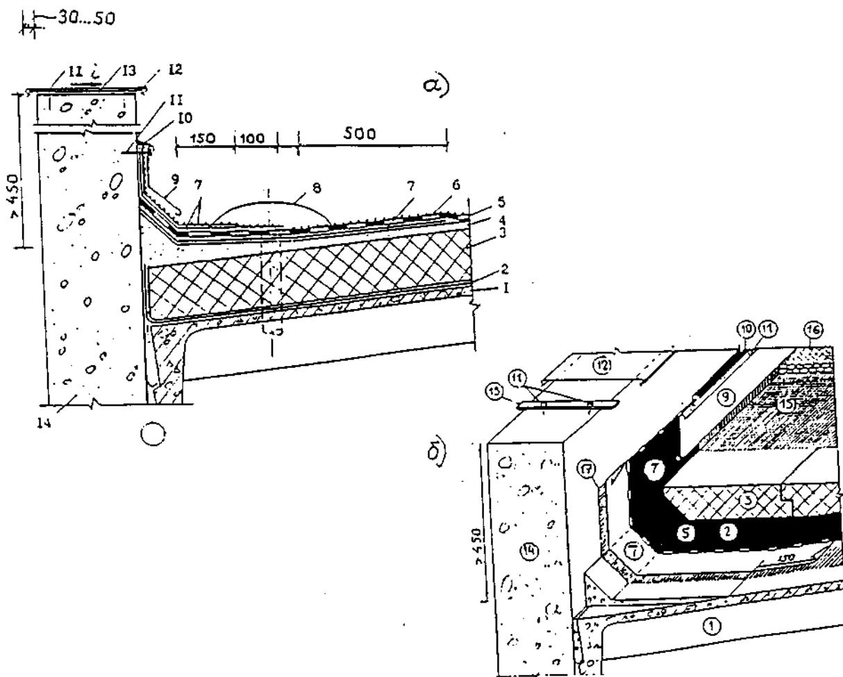
**Рис. 8. Примыкание кровли к парапету высотой более 450 мм**
