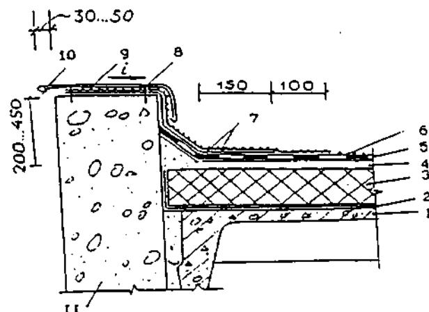
**Рис. 7. Примыкание кровли к парапету высотой до 450 мм**
