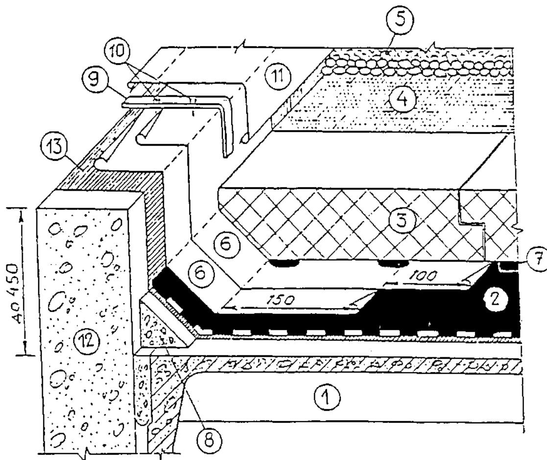
**Рис. 1. Инверсионная кровля с теплоизоляцией из экструзионного пенопласта**
