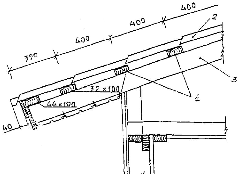
**Рис. 34. Конструкция обрешетки под кровлю из металличерепицы**
