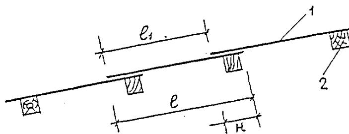
Рис. 5. 1 – асбестоцементный лист, металлический профнастил или металличерепица;
