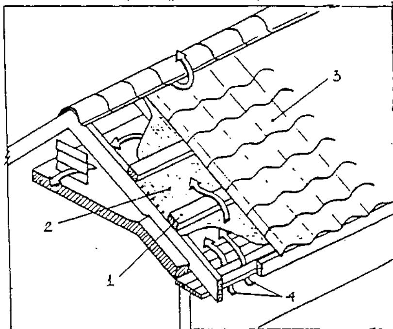
**Рис. 33. Конструкция крыши с кровлей из металличерепицы**
